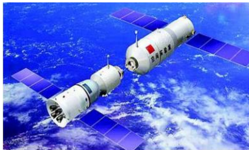
神州11号-返回舱和轨道舱都是铝合金的焊接结构
