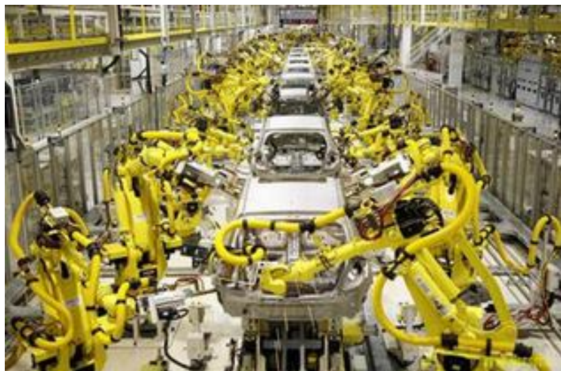
智能化生产车间-焊接机器人
