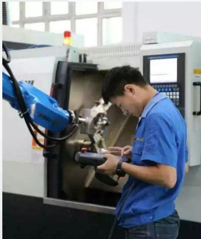
数控设备安装调试
